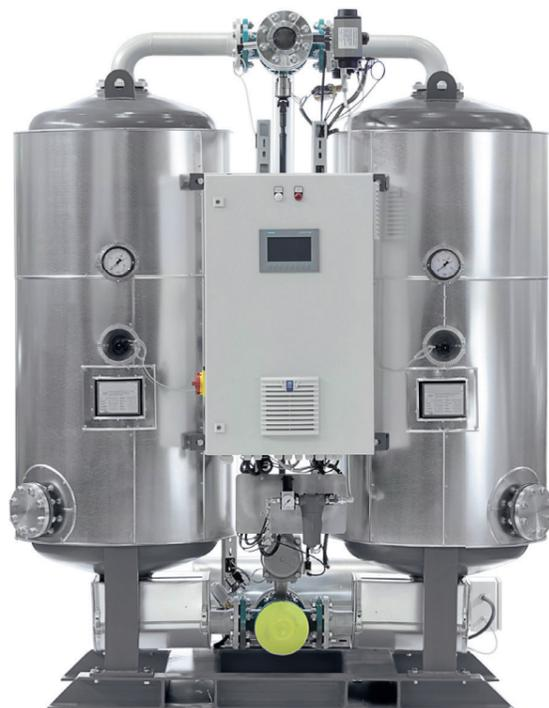
**ПРИ ВЫБОРЕ ОСУШИТЕЛЯ** следует учитывать, что недостатком адсорбционных осушителей сжатого воздуха с холодной регенерацией являются значительные потери осушенного сжатого воздуха: на регенерацию адсорбента расходуется до 20% произведенного компрессором сжатого воздуха.
