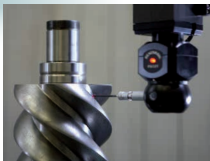
Тестирование качества изготовления винтовой пары при помощи 3D технологий
