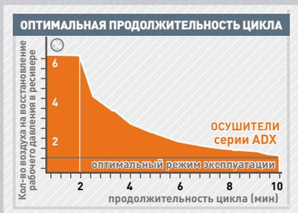
Продолжительный цикл работы уменьшает потери давления воздуха на восстановление рабочего давления в резерве, перешедшем в режим осушки:
