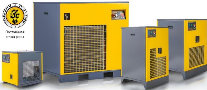
Осушители серии RDX производительностью 0,4-36,0 м<sup>3</sup>/мин изготовлены на основе эффективного литого алюминиевого теплообменника со встроенным коалесцентным сепаратором конденсата. Низкая потеря давления благодаря встроенному сепаратору, и надёжная наружная изоляция теплообменника способствуют высокой энергоэффективности системы. Коалесцентный сепаратор не чувствителен к перепадам давления при непостоянной нагрузке и надёжно отделяет до 98% сконденсированной влаги.
