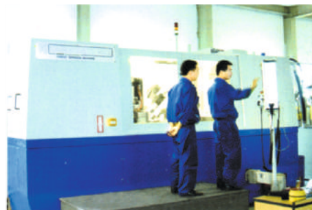
Цифровой шлифовальный станок для Ротора Holroyd TG 150 (Англия)
