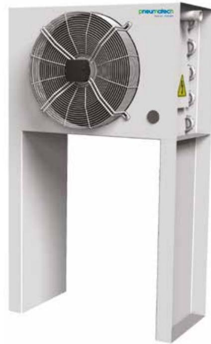
Сжатый воздух на выходе из компрессора всегда на 100% насыщен водой. Кроме того, температура на выходе оказывает большое влияние на водяную нагрузку после компрессора. Чтобы снизить нагрузку и, как следствие, размер расположенных далее рефрижераторных или адсорбционных осушителей, рекомендуется установка высокопроизводительного концевого охладителя между компрессором и осушителем.
