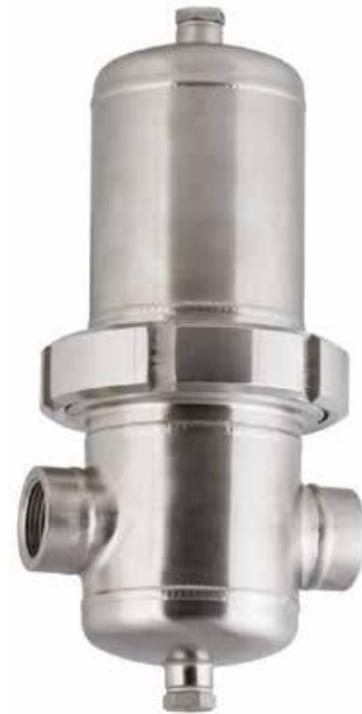
В перерабатывающей промышленности, где риск коррозии компонентов систем сжатого воздуха особенно высок, оптимальным решением является использование линейки технологических фильтров Pneumatech FP 1–18. Корпус фильтра изготовлен из нержавеющей стали марки 1,4301. Поверхность сглажена с помощью передовых методов механической и электрополировки до значения Ra 1,6. Во избежание загрязнения микроорганизмами между головкой и корпусом фильтра они соединены фитингом для молокопроводов согласно DIN 11851.
